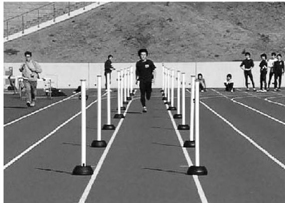
光電管による速度計測（左端が松田君）（2009）
